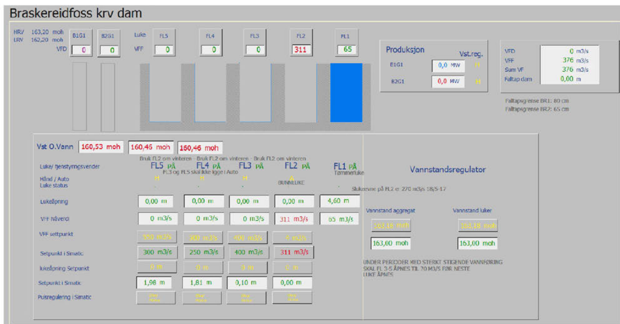
Figur 9 Skjerm bilde for monitorering og drift av luker
