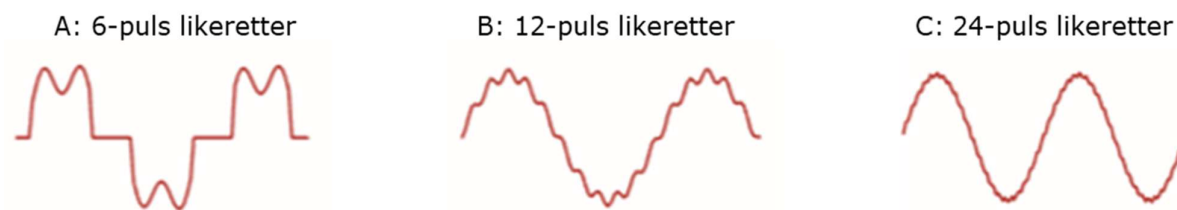
Figur 4-3 Strømkurver for tre ulike typer likerettere – flere pulser er best for strømmettet
