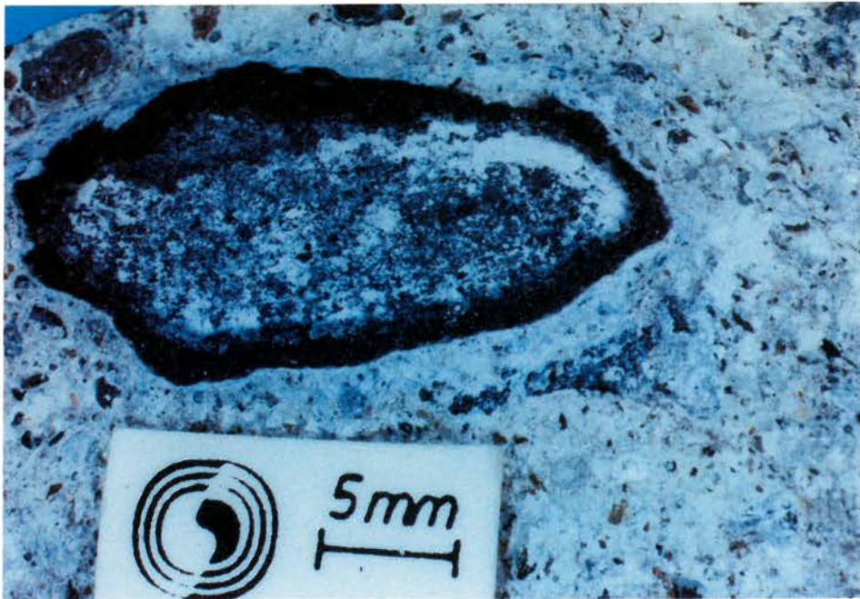
Foto 3 Reaksjonsrenner i reagert tilslag. Merk den mørke ytre randen og hvite utfellingsprodukter inne i tilslaget
