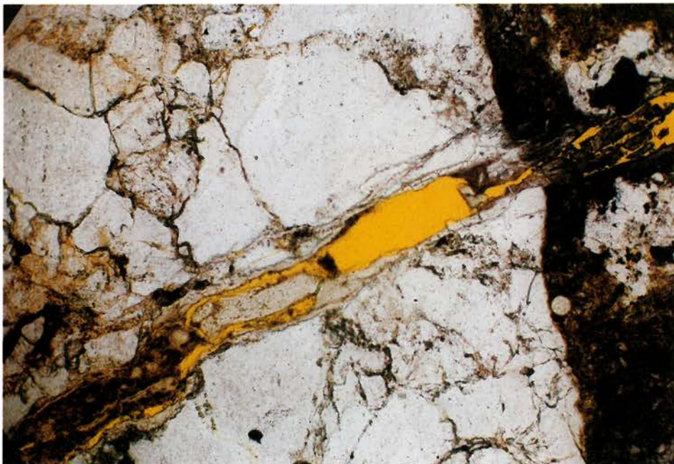
Foto 4 Reagert sannstein. Merk at et riss kan følges fra tilslaget og ut i sementpastaen og at reaksjonsprodukter finnes både i tilslaget og i sementpastaen
