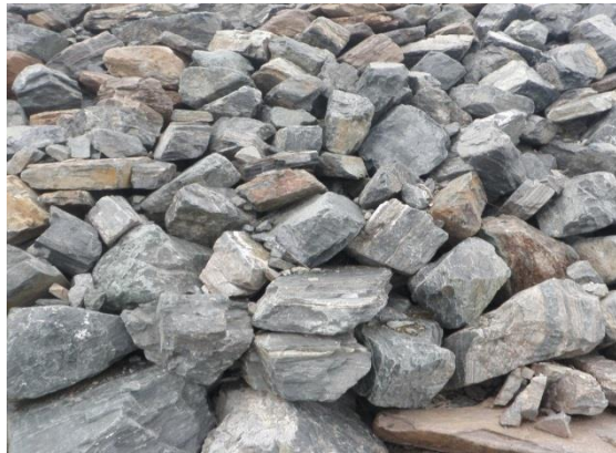
Figur 18 Stor variasjon i steinstørrelse og mange små steiner. Vessingsjø sekundærdam.
