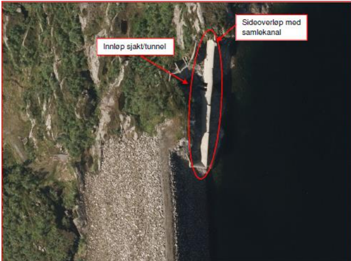
Figur 7-1 Den vel 50 meter høye fyllingsdammen ved Stølsvatnet i Modalen er bygget med lukka flomløp.
